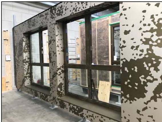
FOTO 2: GEVELELEMENTEN VOLLEDIG GEPREFABRICEERD IN DE FABRIEK, D.D. 21-06-2020 (EIGEN FOTO).
