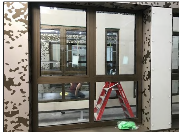
FOTO 2: GEVELELEMENTEN VOLLEDIG GEPREFABRICEERD IN DE FABRIEK, D.D. 21-06-2020 (EIGEN FOTO).
